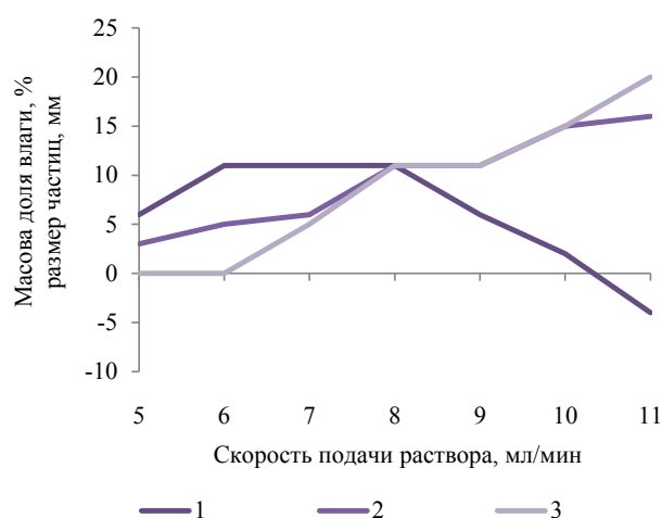
Рисунок 3. Зависимости массовой доли влаги, выхода продукта и размера частиц гидролизата от скорости подачи раствора в установку: 1 – выход продукта; 2 – массовая доля влаги; 3 – размер частиц, P < 0,05
