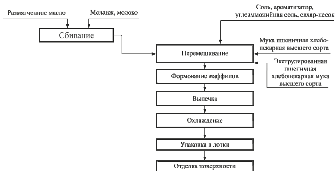
Рис. 3. Технологическая схема производства маффина классического
