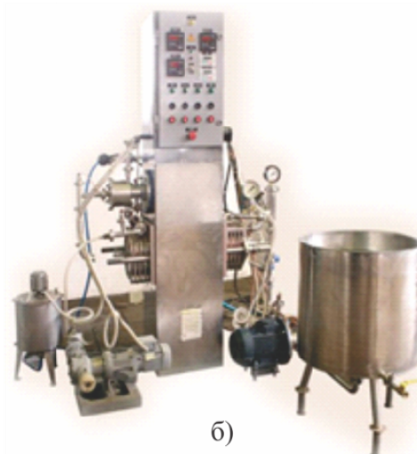
Рис. 1. Установка для поточной кристаллизации лактозы: а – принципиальная схема, б – общий вид:
